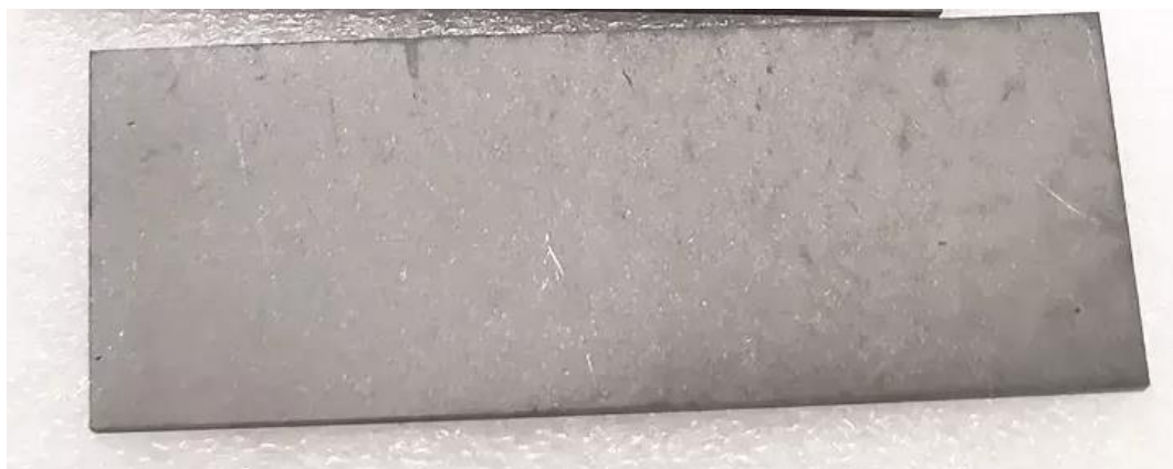
Рис. 1. Пластика с нанесенным покрытием из карбида вольфрама
