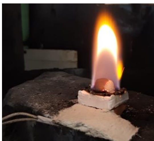
Рис. 2. Внешний вид эксперимента с мастикой толщиной 10 мм
