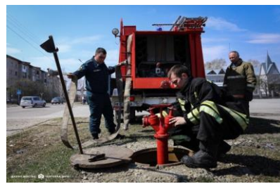
Рис. 3. Метод обследования при помощи автонасоса
