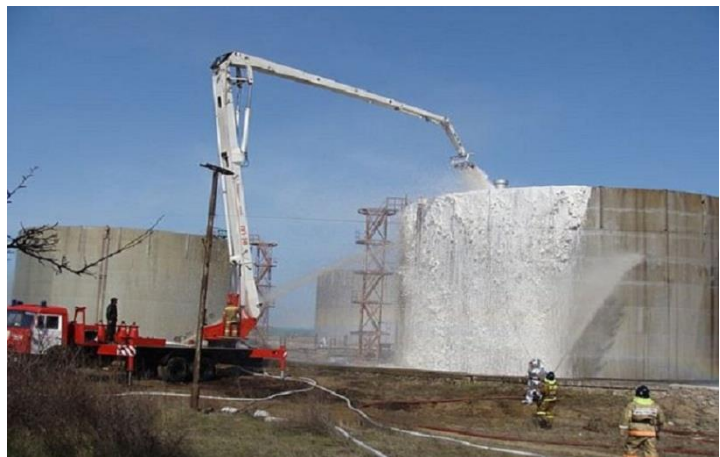
Рис. 3. Тушение нефтеналивного резервуара с перекошенной крышей
