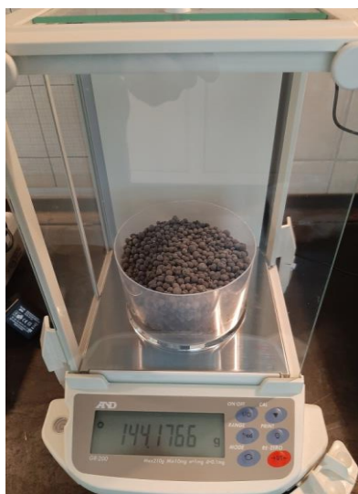
Рис. 1. Емкость с СГП на весах GR-300
