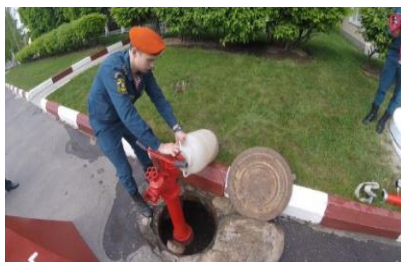
Рис. 1. Определение расхода отношением объема вылившейся жидкости к времени за которое наполнился емкость
