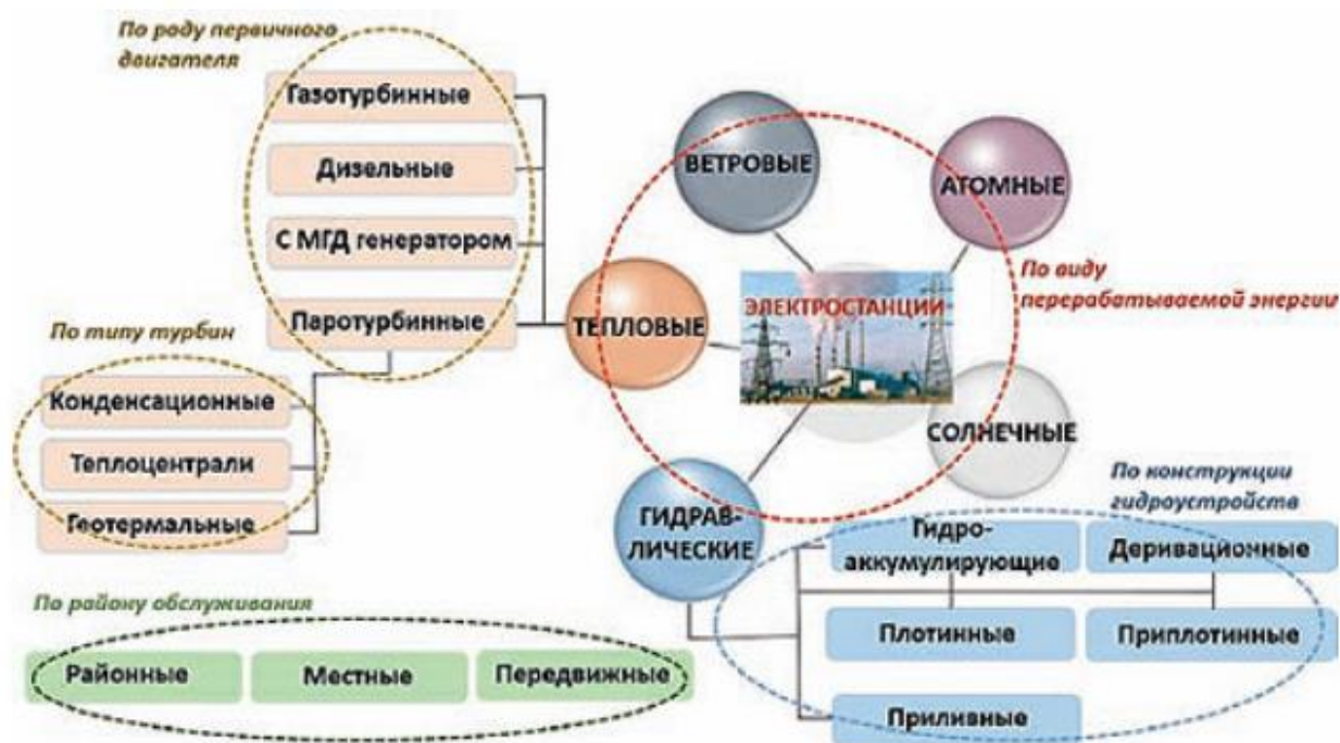
Рис. 1. Классификация типов электростанций в зависимости от различных параметров
