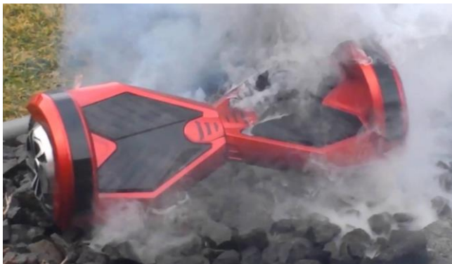
Рис. 2. Вид начальной стадии горения гироскутера
