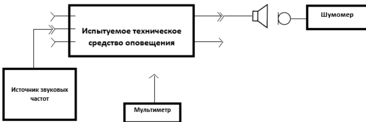
Рис. 1. Структурная схема подключения испытательного оборудования и средств измерений для проведения сертификационных испытаний
