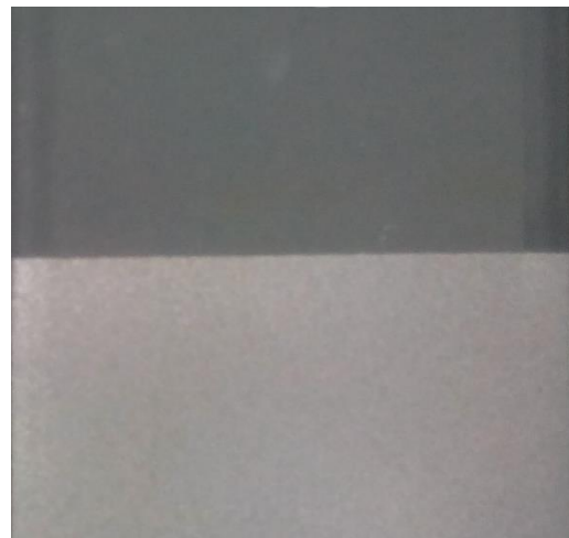
Рис. 1. Комбинированное многокомпонентное покрытие (40% ПТ-НА-0.1-30% Al-30% Zn) +ЦИНЭП+ ПР-Н70Х17С4Р4
