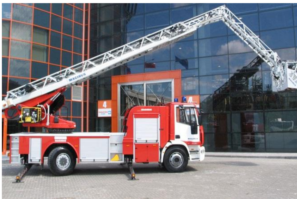
Рис. 3. Разложенная пожарная автолестница MAGIRUS M 32 L-AS
