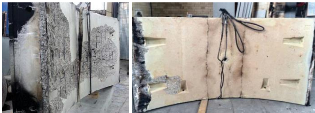
Рис. 2. Результаты испытаний в режиме стандартного пожара
