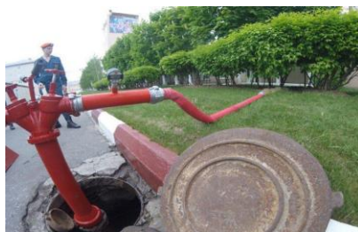
Рис. 2. Метод определения расхода с помощью показания манометра
