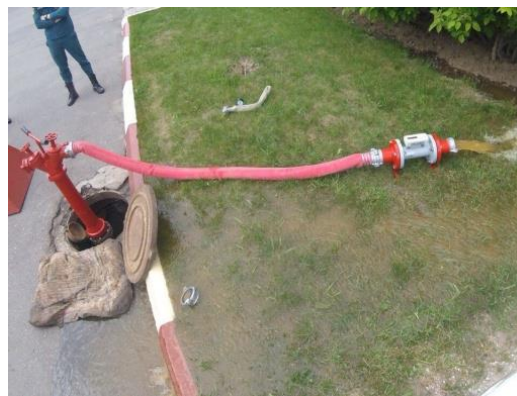
Рис. 4. Отличительной чертой этого способа является его простота и быстрота, для проведения испытания достаточно одного оператора и в среднем 3-4 минут времени
