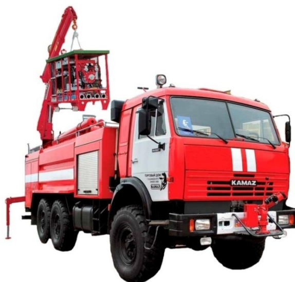
Рис. 4. Пожарно-спасательный автомобиль с роботизированными мобильными установками для тушения нефтеналивных резервуаров (ПСА РМУТНР)
