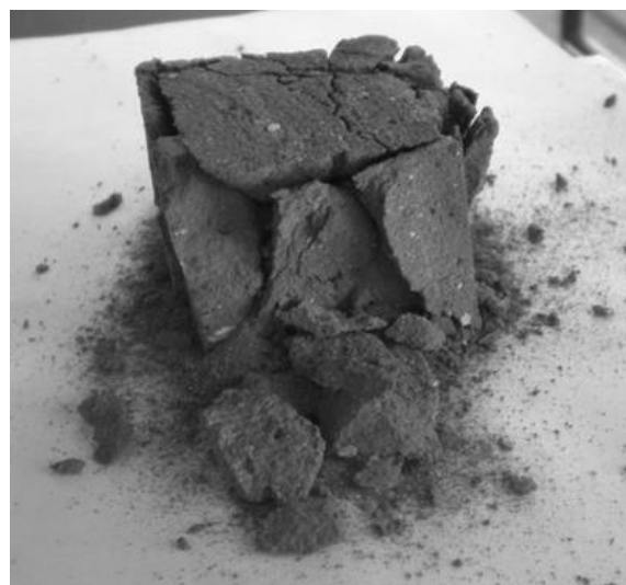
Рис. 3. Характер разрушения лабораторных образцов, предварительно нагретых до высоких температур
