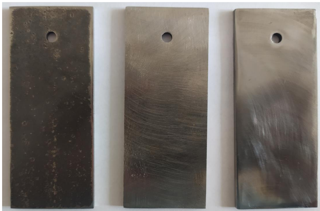
Рис. 2. Образцы стали марки Ст3 с различным качеством предварительной обработки
