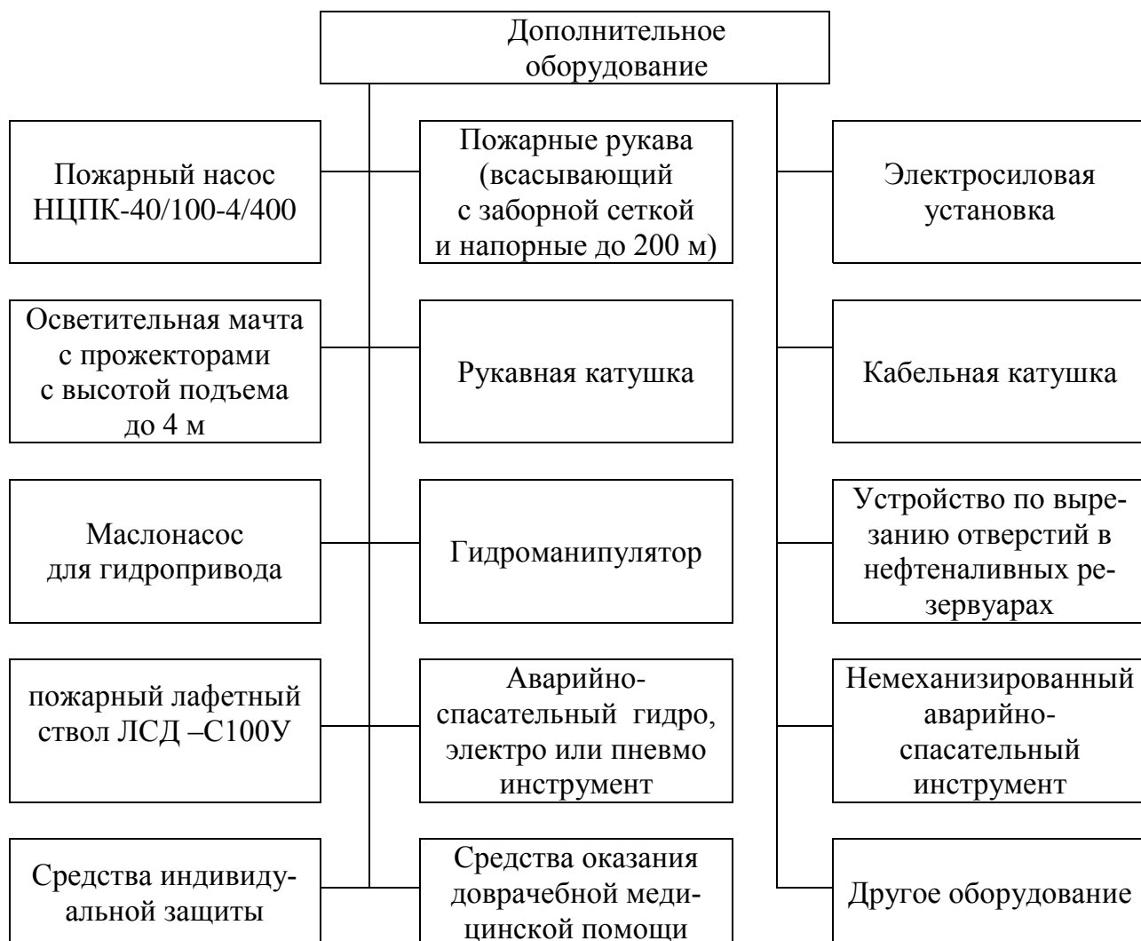
Рис. 5. Принципиальная схема комплектации оборудованием пожарно-спасательного автомобиля
