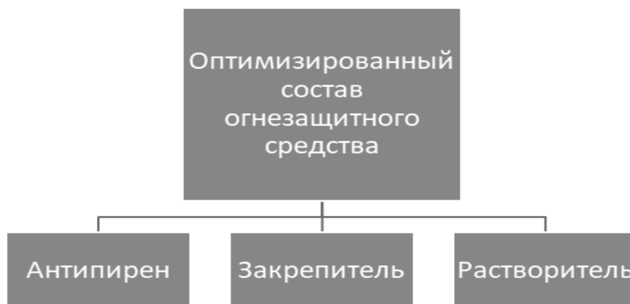
Рис. 2. Предлагаемая структура огнезащитной композиции
