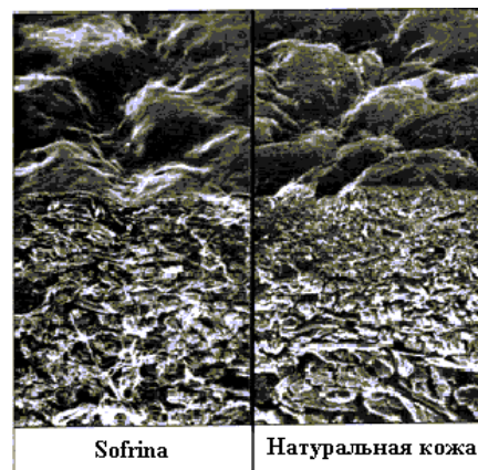
Рис. 1. Внутренняя структура синтетической кожи нового поколения марки «Sofrina» и натуральной кожи
