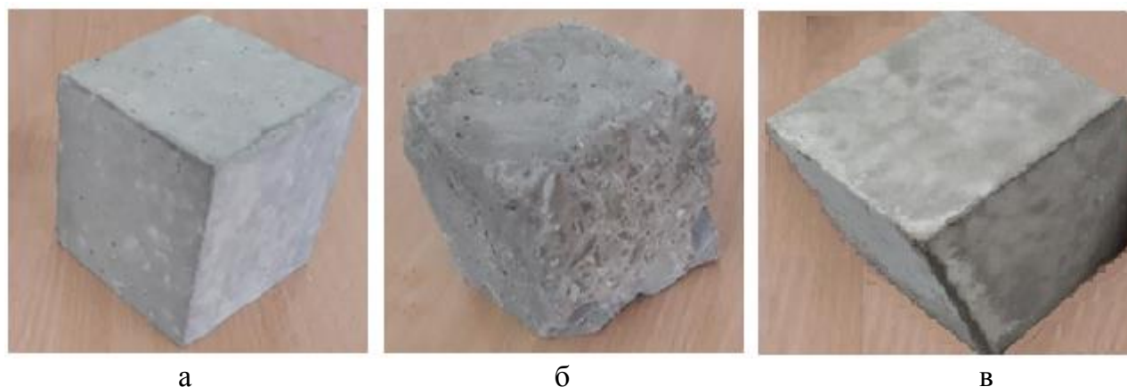
Рис. 2. Бетонные образцы для исследования прочностных свойств: а – исходный образец после застывания бетона, б – образец находящийся при эксплуатации на улице, в – образец подвергающийся воздействию влажной среды
