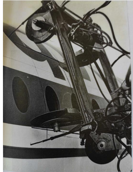
Рис. 2. Установка для вырезания окна в фюзеляже самолета при помощи корундовых дисков с электроприводом
