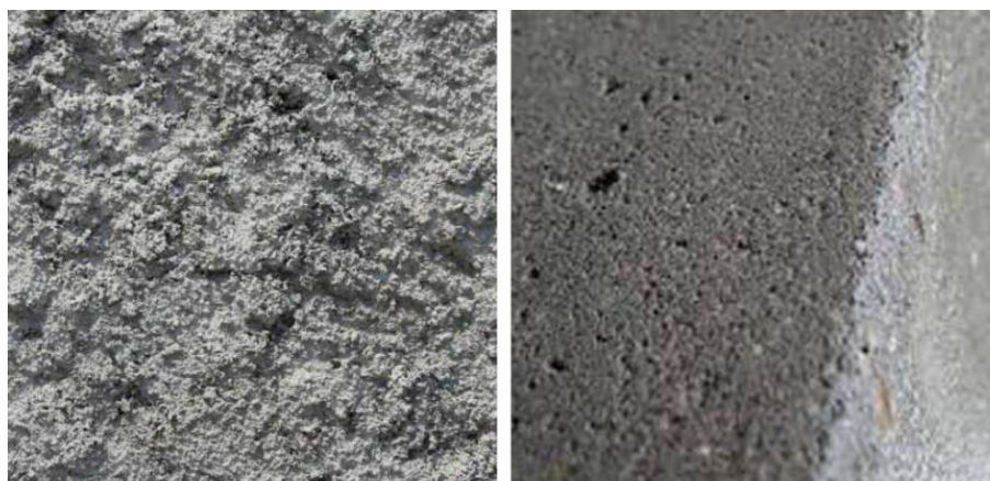
Рис. 1. Структура бетона в жидком состоянии (слева) и при затвердевании (справа)
