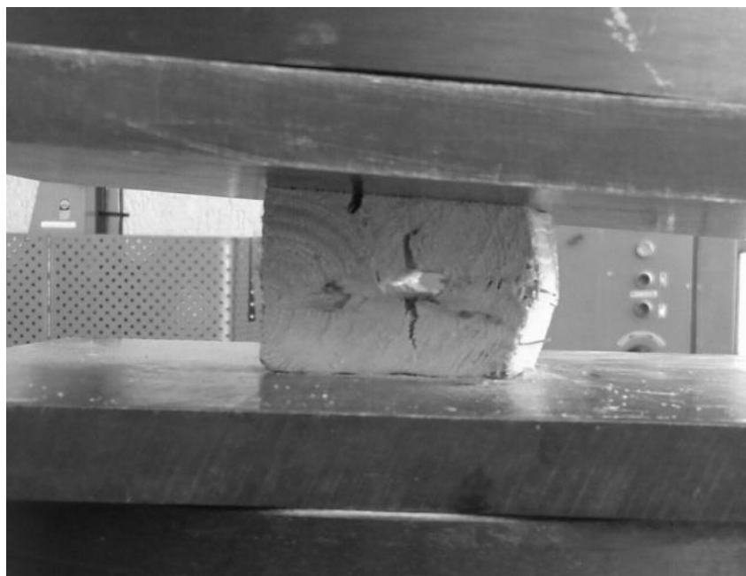
Рис. 1. Проведение испытания образца на сжатие
